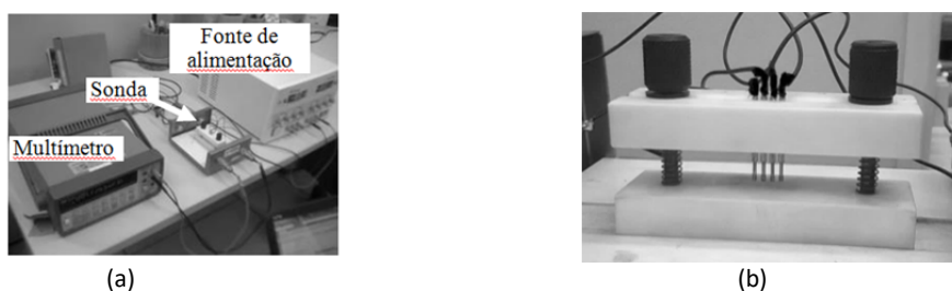
Fig. 1. (a) Bancada para cálculo da condutividade elétrica através do método de quatro pontas e (b) detalhe da sonda de quatro pontas.
